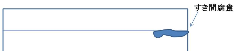
図 2. ステンレス鋼のすき間腐食
