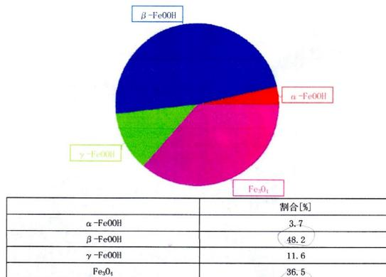
図6 さびの X 線回折結果
