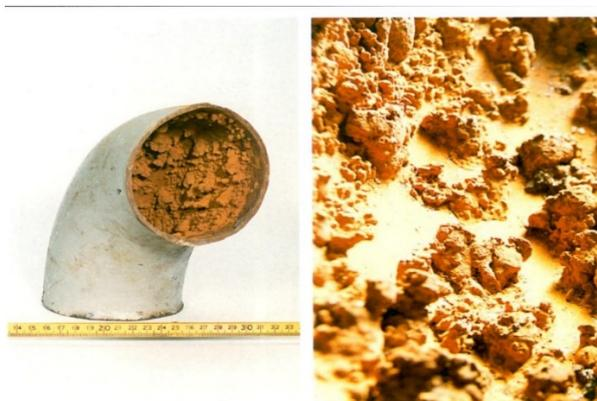
図1 水道管の腐食
