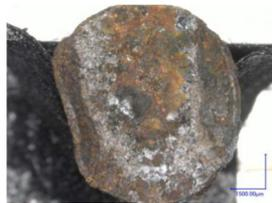
図5 建築用に長期間使用された釘の腐食
