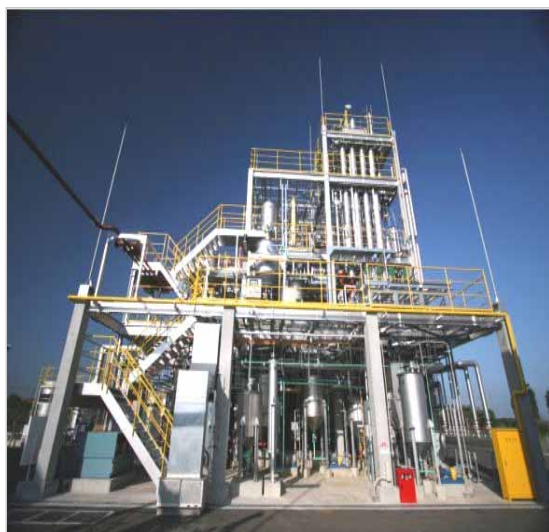
図 5 . 有機塩素化合物亜臨界分解プラント ( 近畿環境興産(株)御提供 )
