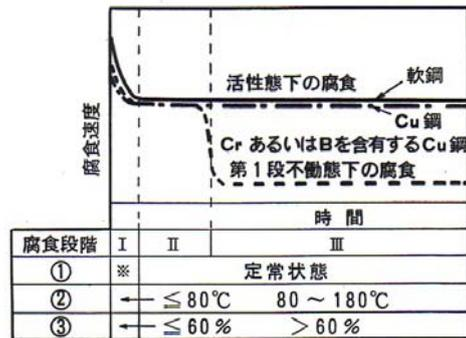
図 7 硫酸露点腐食機構
